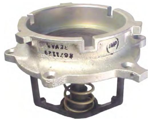
Las fugas durante el repostaje están a menudo causadas por un desgaste excesivo de alguno/s de los tetones localizados en el borde del adaptador de repostaje. Este desgaste reduce la presión de sellado entre el boquerel y el adaptador, con la consiguiente fuga.
