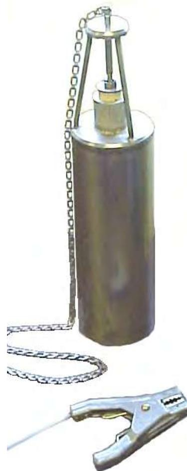
El modelo GTP-9021 fue desarrollado específicamente para caber dentro de los pequeños orificios encontrados en las bases aéreas de la U.S. Airforce, donde además se encontraron cables presentes dentro de los depósitos. Por tanto era importante evitar enredos con la cadena del tomador de muestras y así como evitar producir daños a dichos cables. Por esto, el diámetro exterior es de sólo 3.1" (79 mm).
