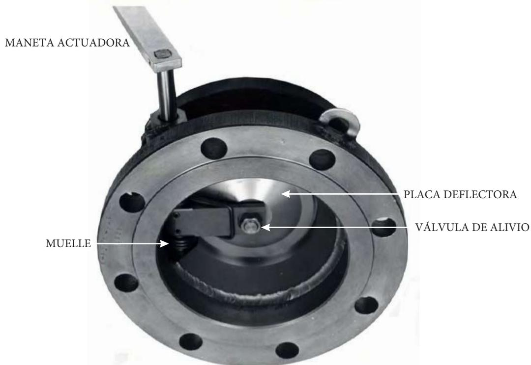
Esta válvula posee características especiales necesarias para pasar el test API-6FA. Esta prueba requiere que los valores de fuga a través de la válvula no excedan unos valores determinados tras la combustión de las juntas a una temperatura de de 870°C. Para cumplir este requisito era imposible usar juntas de anillo, así que usamos un tipo único de montaje de junta tipo laberinto usada y probada en otros productos de nuestra fabricación.
