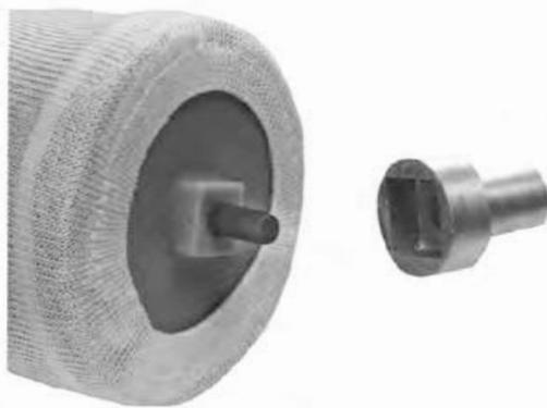
Diseñado para ser compatible con mezcladores tipo Velcon Filter, Inc. TB, este adaptador sirve también para llaves dinámicas y cuadradas de 1/2". Velcon recomienda un par de apriete de 30 lbs-ft en elementos mezcladores. Es necesario usar una llave dinámica cuando se trabaje con elementos mezcladores Velcon.
