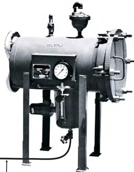
Manguera de succión conectada a recipiente para vaciado o para descargar en depósito subterráneo
