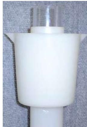
Algunos clientes prefieren realizar la lectura a través de cristal en lugar de realizar una estimación en la parte superior del tubo central de plástico del modelo GTP-1073. Para estos clientes, disponemos de un pequeño tubo de cristal que encaja dentro del tubo central de plástico y puede ser almacenado ahí. Para realizar la medición, simplemente tire del tubo para sacarlo de su posición de almacenaje.
