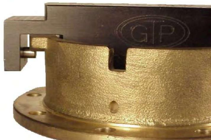
Un fallo en el sellado del sistema puede desembocar en un gran derrame, debido a la desconexión entre el boquerel y el adaptador durante la operación. Un límite de desgaste en las ranuras del adaptador es de 0.062 pulgadas.
