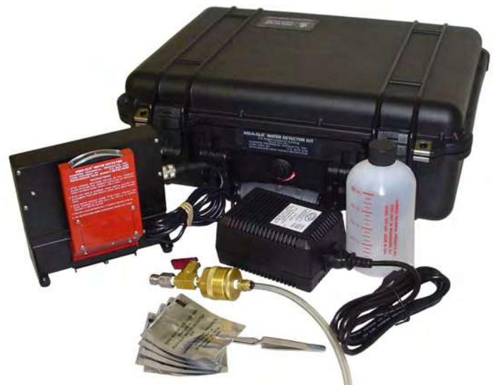
Esta prueba requiere dos simples pasos. Primero, una muestra medida de combustible pasa a través de una lámina de papel tratada con sodio fluorescente en su cara aguas arriba. Segundo, la lámina se compara con un fluorescente estándar bajo luz ultravioleta. Las gotas de agua más pequeñas de lo que puede ver el ojo humano causan la fluorescencia del sodio. El grado de fluorescencia es mayor a mayor cantidad de agua en el combustible.
