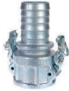
BOSS-LOCK TIPO C P/MANG. CON SEGURO DE ANILLAS MATERIALES : AL, BR, INOX Y HIERRO CINCADO TAMAÑOS : de 1/2" a 4" hasta 8" en aluminio, 6" en hierro y bronce en embocadura de 3/4"
